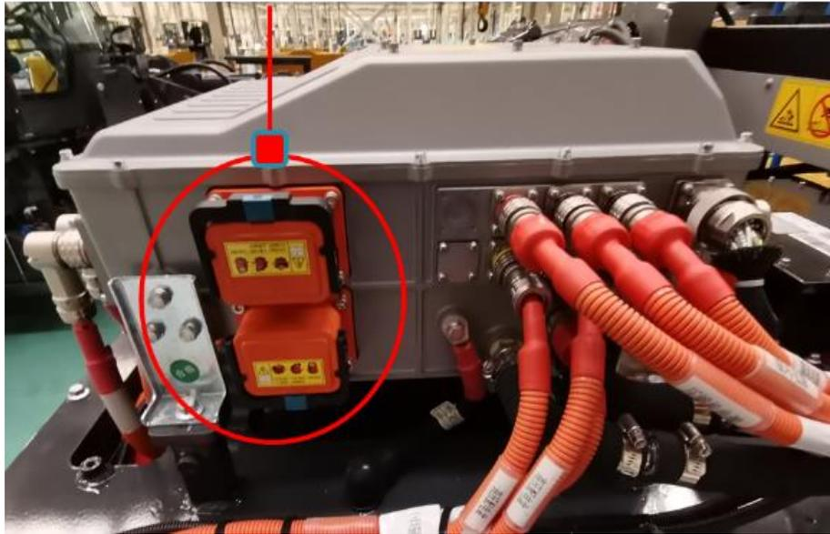
El fusible de protección HVB (MSD) es un componente eléctrico. Se utiliza para aislar manualmente líneas de alta tensión y proteger al personal de mantenimiento. El técnico responsable debe desconectar el fusible MSD antes de realizar operaciones de mantenimiento en el equipo. Después de completar los trabajos de mantenimiento, es necesario volver a conectar el MSD. Sólo Técnicos Certificados están autorizados a interactuar con componentes de alto voltaje.
